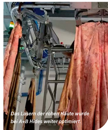
Die Kennzeichnung jeder Haut übersteht den gesamten Gerbprozess, so dass das Leder eindeutig zugeordnet werden kann. Fotos: A+B Hides
